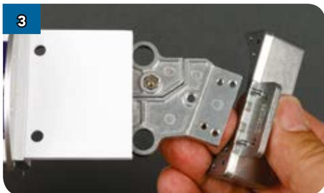
3 Совместите деталь (LFL-05) с металлическим каркасом: два её установочных штифта должны совпасть с соответствующими отверстиями в каркасе опоры.
