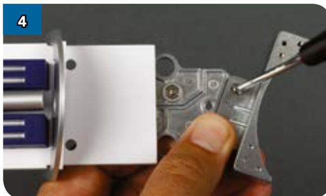
4 Плотно прижмите деталь (LFL-05) к каркасу, после чего закрепите её двумя серебристыми винтами.
